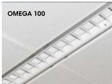
Der integrierte Leuchtenkanal des modernen S-OMEGA TAIFUN Decken-Lichtsystems besteht aus eloxiertem Aluminium und ist standardmäßig mit LED Leuchteneinsätzen und opaler Folie bestückt. Die Leuchtmittel werden durch ein ballwurfsicheres Raster nach DIN 18032-3 Klasse 1A vor mechanischen Einwirkungen geschützt.
