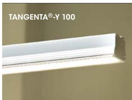
Mit einer Breite von 100 mm integriert sich die moderne LED-Leuchte TANGENTA®-Y 100 unauffällig im Raum. Mit einer ballwurfsicheren Glasabdeckung zeichnet sie sich durch eine sehr hohe Lichtintensität aus und ist durch DALI-Dimmung mittels geeigneter Anwesenheits- sowie tageslichtabhängiger Steuerung extrem wirtschaftlich.
